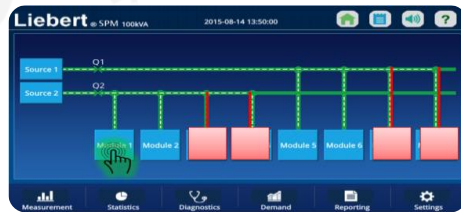
系统单线图集中监控
